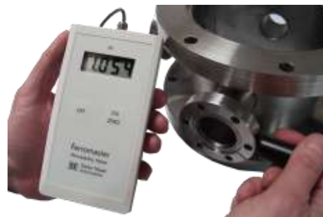
低透磁率計(μ メータ) フェロマスタ
