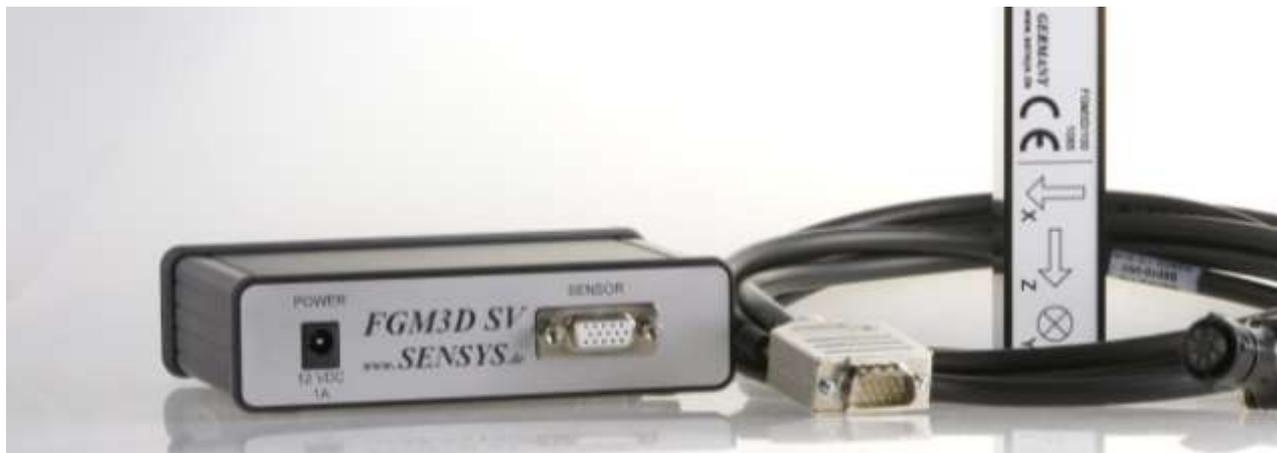
FGM3D SV は FGM3D シリーズセンサに電源を供給し、3 軸の出力を BNC コネクタで個々に出力します。
