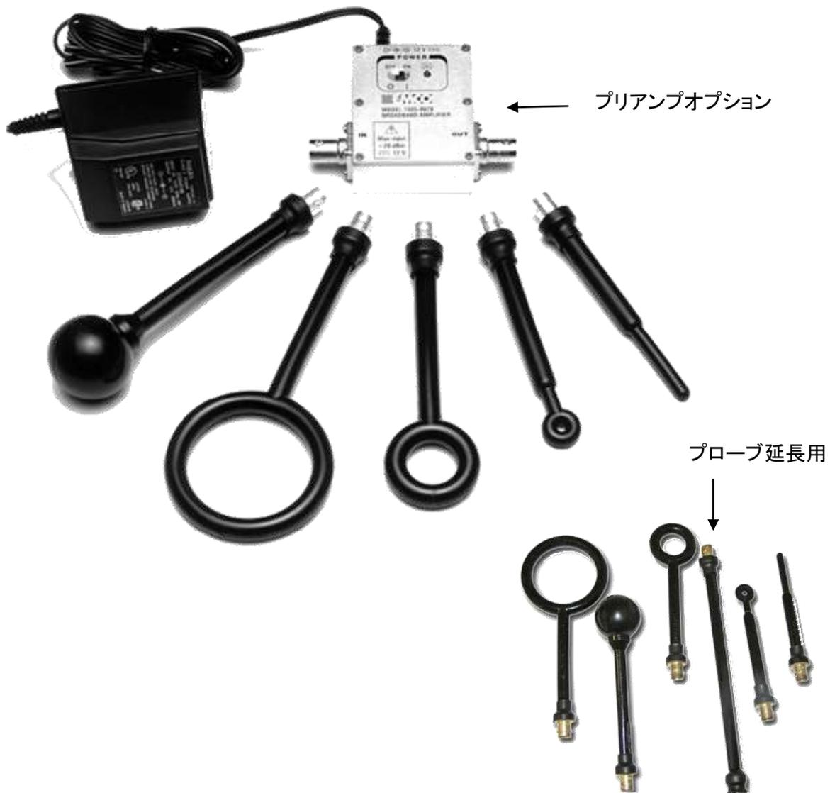
7405 ニアフィールドプローブセットはHフィールド用 6cm, 3cm, 1cm ループプローブ及び E フィールド用 3.6cm ボールプローブ、6mm スタブチッププローブで構成され、オプションでプリアンプが用意されています。EMC 初期診断試験に最適です。
